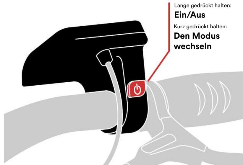
Einmal eingeschaltet, können Sie mit den Tasten + und - auf der Vorderseite des Displays durch die 5 Stufen der Motorunterstützung scrollen. Detaillierte Anweisungen für Ihren Bildschirm finden Sie in der Bafang-Anleitung, die Sie auf unserer Website im PDF-Format finden.
