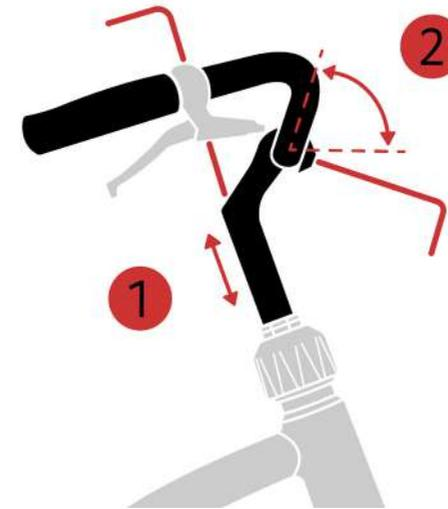
Tipp: Wenn Sie die Winkel Ihrer Griffe, Bremsen und Schalthebel einstellen möchten, können Sie dies mit einer einfachen Drehung des Imbusschlüssels (3 oder 4 Umdrehungen). Allerdings sollte dies bereits richtig eingestellt sein.
