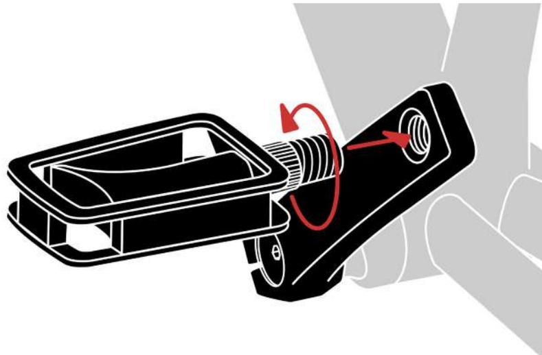
**RECHTES Pedal:** Dieses Pedal hat keine einbezogenen Linien und ist glatt zwischen Pedal und Gewinde.
